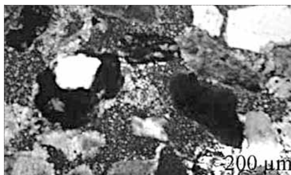
ب- نمایش قطعات فلزی کدر و غیر فلزی شفاف را نشان می‌دهد که مورد اخیر شامل کوارتز (بی‌رنگ) و کربنات‌ها (قهوه‌ای) است. رس‌های مونت‌موریلونیت به‌رنگ سبز دیده می‌شود. (فراکسیون ۳/۳۵ میلیمتری با نور معمولی)
