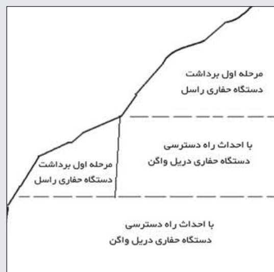
شکل ۳: مراحل برداشت سنگی با دستگاه‌های حفاری
