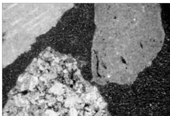
د- سه قطعه مجزا را نشان می‌دهد که قطعه قهوه‌ای بوکسیت، خاکستری کلسیت و قطعه‌ی پائین میلونیتی از کربنات‌ها با سایر ترکیبات هستند. (فراکسیون ۳/۳۵ میلیمتری با نور معمولی)
